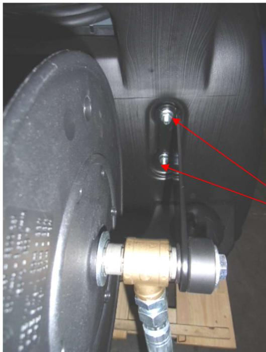
Retrait des deux capuchons présents sous la poignée et montage des supports d'enroulement du tuyau, en les fixant avec les 4 vis fournies dans le kit.
